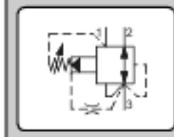
**C06B3H** UP TO **200 L/MIN 53 USGPM**
